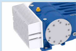
Luftkühler und Sumpfschmierung. Bis 35°C Umgebungstemperatur. Bis 45 kW / 450 rpm.*
