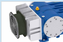
Luftkühler mit Ventilator und Sumpfschmierung. Bis 45°C Umgebungstemperatur. Bis 65 kW / 650 rpm.*
